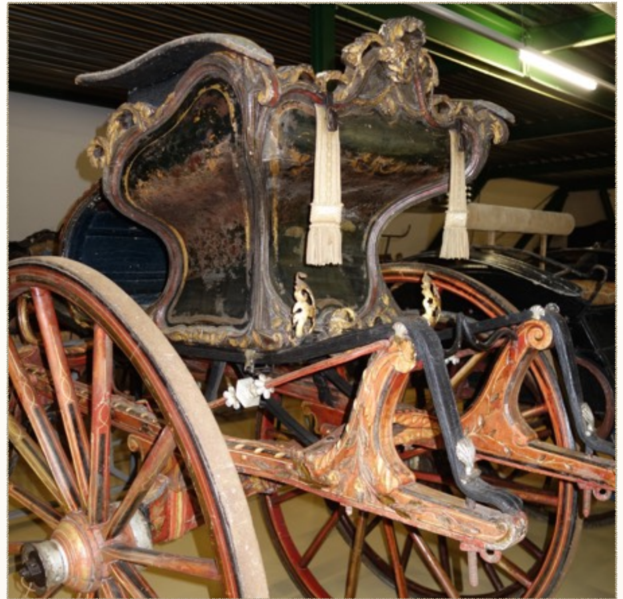
Abb. 43 Detail einer zweirädrige westfriesische Chaise („Siees“) mit auf Tragriemen liegendem Kasten des späten 18. Jahrhunderts im Museum Leek NL. Diese Konstruktionsart ist ein Beispiel für hölzerne Gestellarme mit schräger Eisenverstärkung als Auflagefläche für die Tragriemen.
