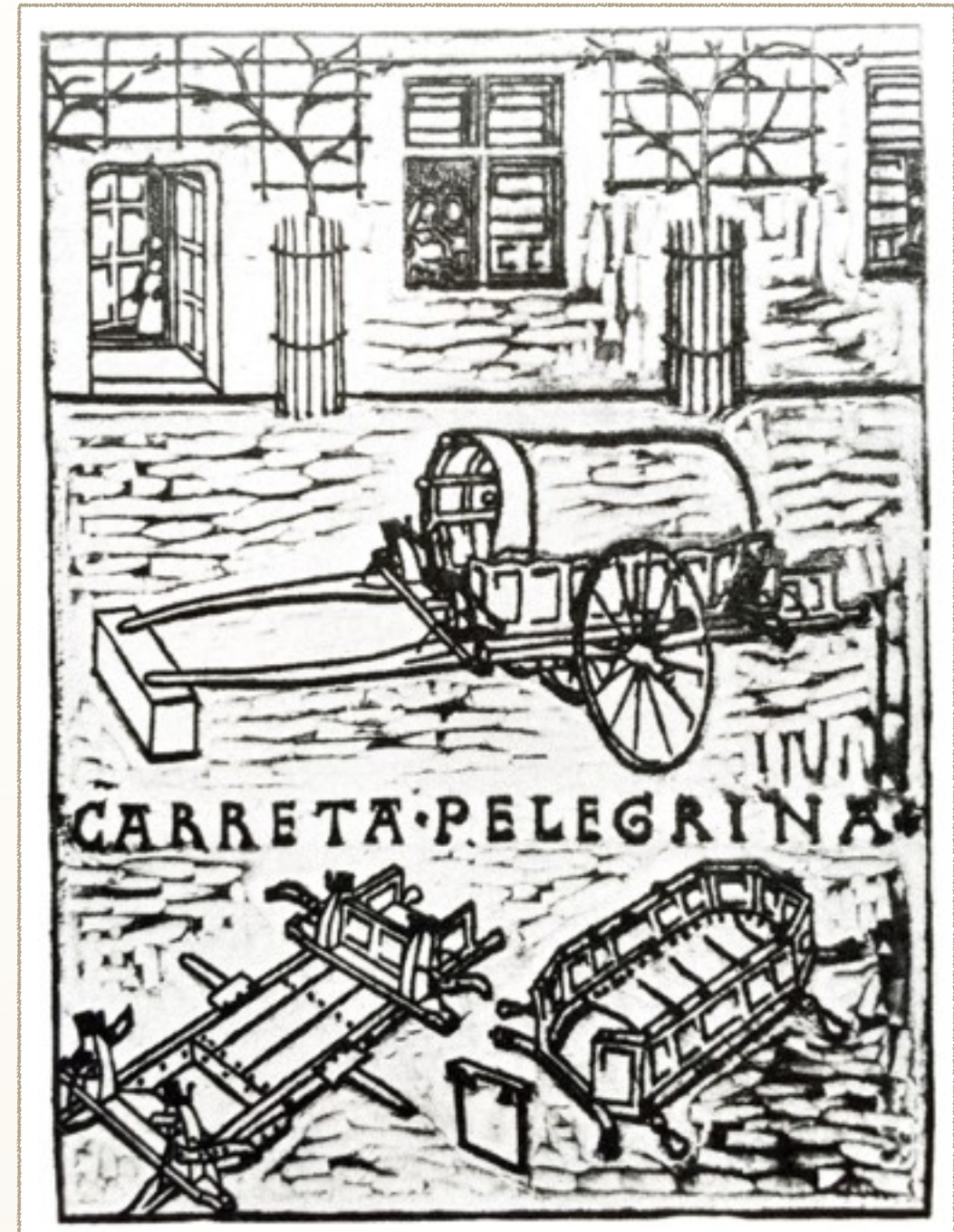
Abb. 38 Zweiradwagen mit vier fast senkrecht in Querarme (Kipfstöcke) des Gestells eingezapften Kipfen. Daran wurde der Kasten mittels Riemen, Seilen oder Ketten schwingend aufgehängt. Carreta nach einem Stich von Jean Pelerin um 1509.
