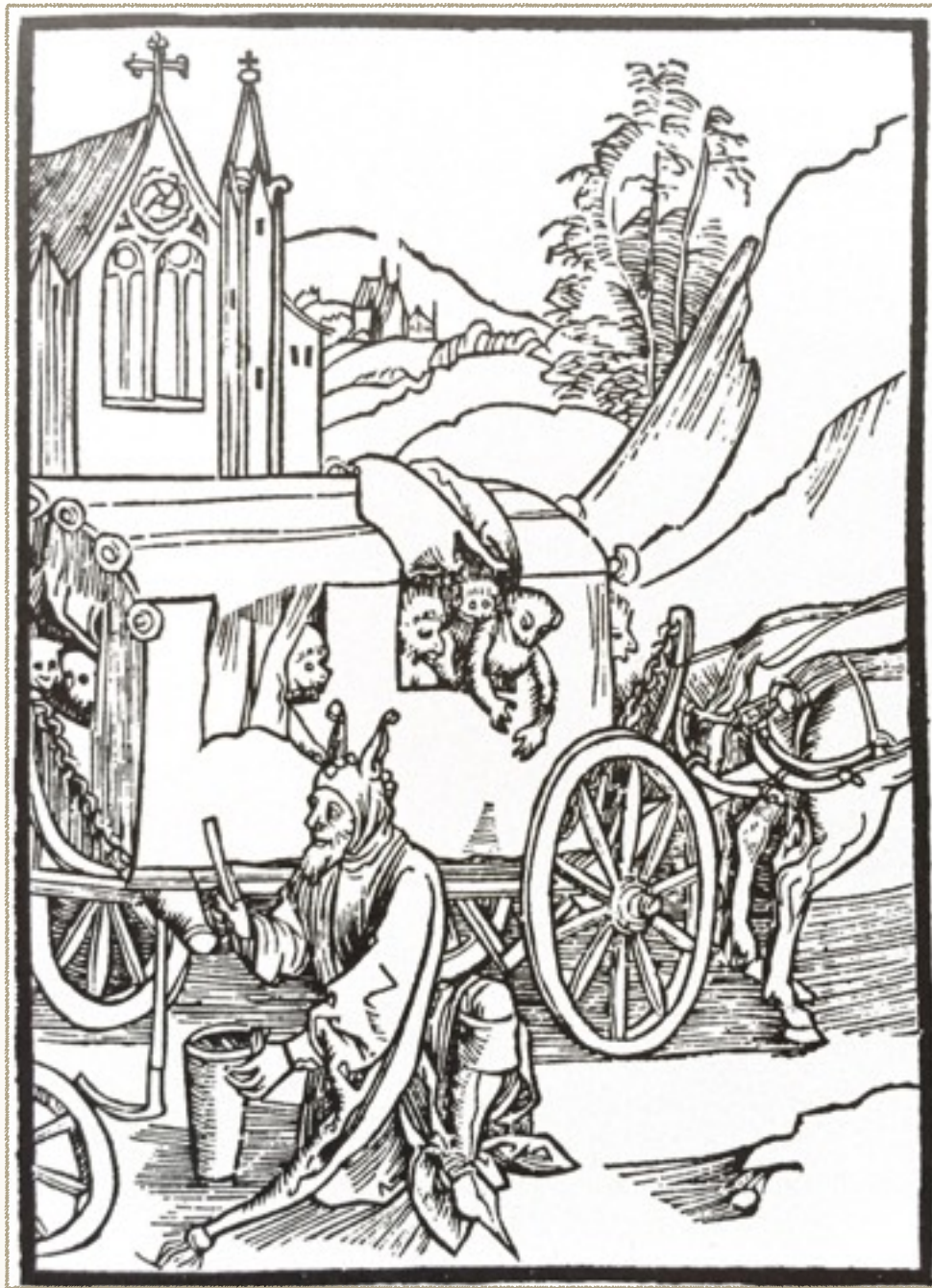
Abb. 37 Kobelwagen mit in Ketten hängendem Kasten, die an aufgebogenen Gestellarmen festgemacht sind. Affenwagen nach einem Holzschnitt von Albrecht Dürer von 1495.
