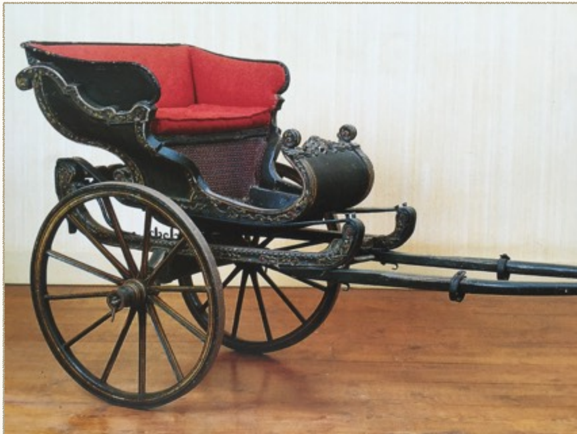
Abb. 42 Zweirädrige friesische Chaise („Bokkesjees“) mit auf Tragriemen liegendem Kasten des frühen 18. Jahrhunderts im Museum Leek NL. Die Gestellarme, über die die Tragriemen längs gespannt sind, bestehen aus Holz.
