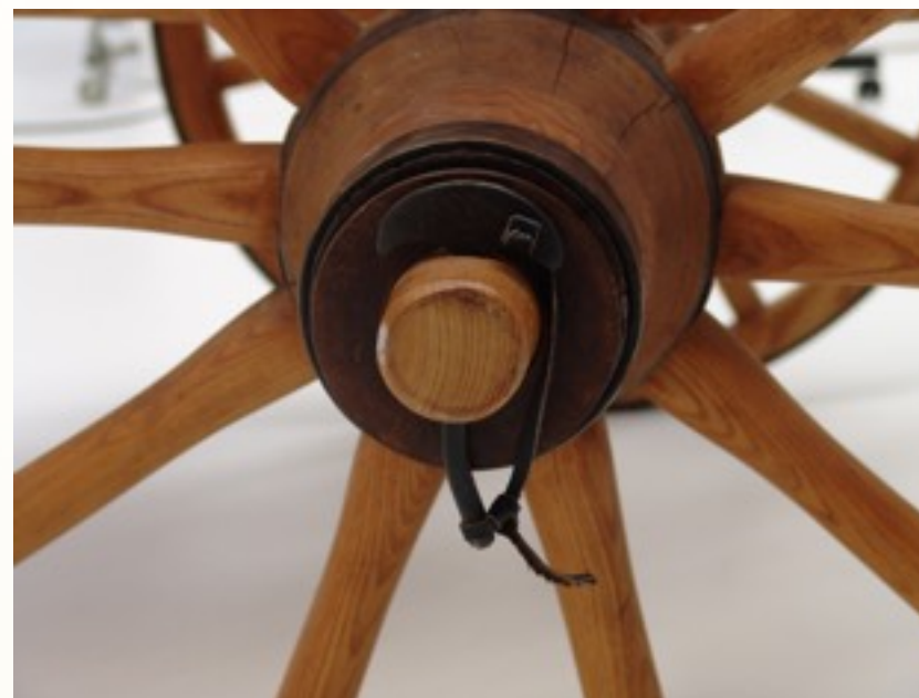
Abb. 17 Detail der Holzachse und der Radnabe mit Achsstecker des rekonstruierten Wagens nach einem Fund von La Tène.
