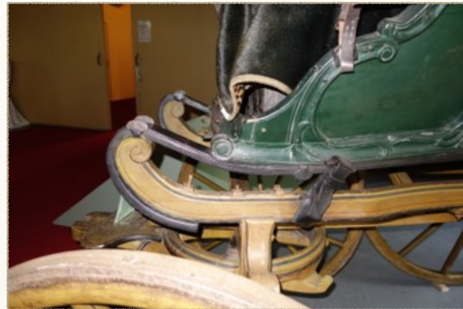
Abb. 45 Vierrädriger Reitwagen aus Brabant des 18. Jahrhunderts im Museum Leek NL. Dieses Beispiel zeigt eine traditionelle Lösung der die Federungsriemen tragenden Gestellarme aus Holz. Sie erinnert an die mittelalterliche Darstellung von Abbildung 35.
