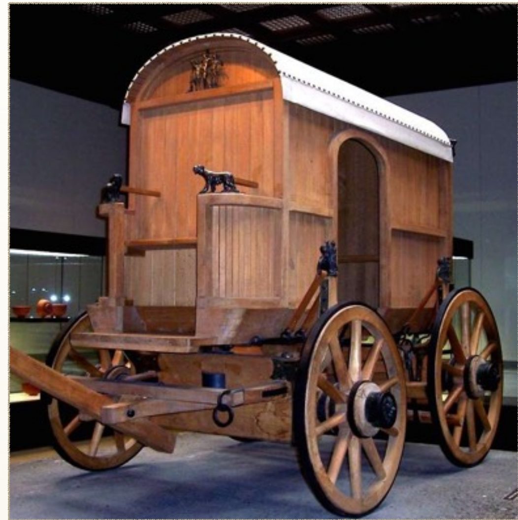
Abb. 31 Die Rekonstruktion eines römischen Reisewagens mit Querfederung des Römisch-Germanischen Museum Köln.
