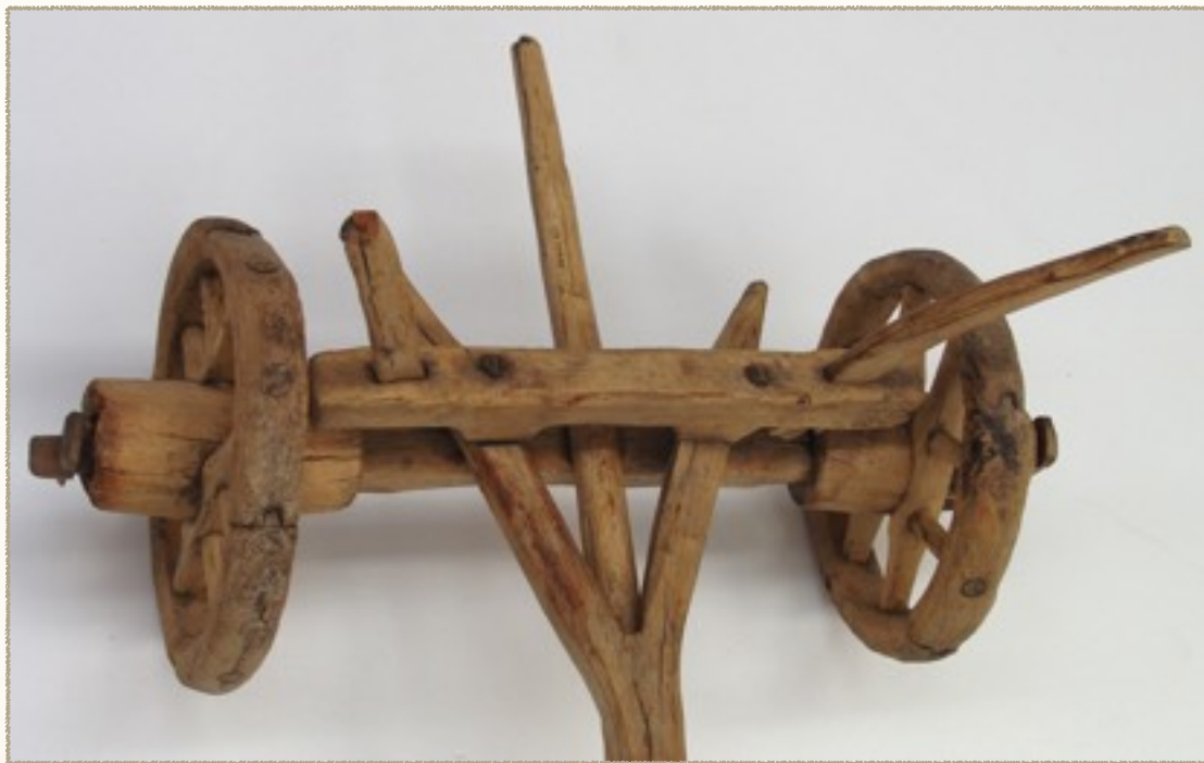
Abb. 32 Aufsicht und Detail der hinteren Partie eines ungefederten bäuerlichen Fahrzeugs des 19. Jahrhunderts mit altertümlichen Strebenrädern und Reibschaitlenkung, das ganz ohne Metallteile ausgeführt ist. Solche Wagen hinterliessen im Boden keinerlei Spuren.
