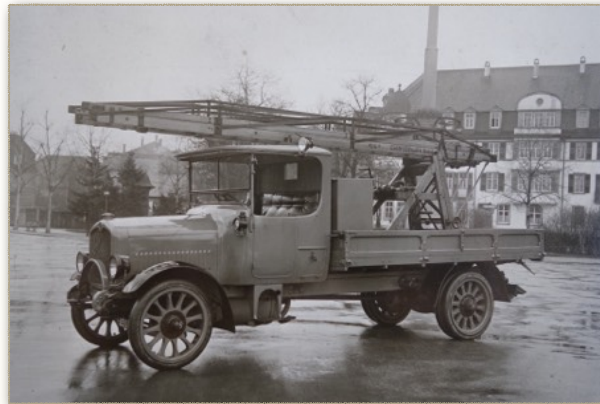
Abb. 64 Automobil mit Drehleiter-Aufbau von Julius Kölz.
