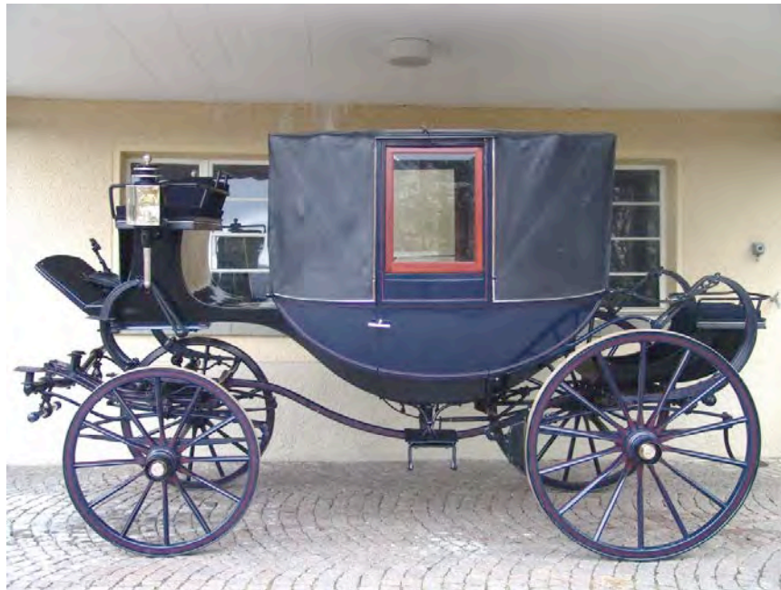
150 Englischer, achtfach gefederter Leder-Landauer mit Kasten in Schiffsform der Zeit um 1870.
