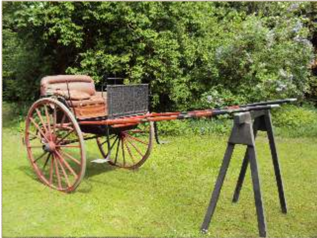
Texas Cart mit Kapseltyp 4. Originalzustand, mit Handbremse (Erstbesitzer Familie Bühler, Uzwil SG)
