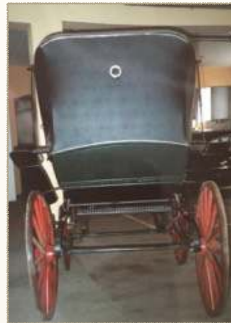
Chaise mit Kapseltyp 3. Modell ohne Türen. Bremse hinten und vorne. (1989 bei Neck in Neuhausen SH)
