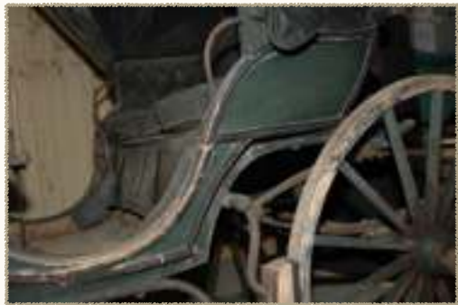
Victoria-Duc Nr. 1210 mit Kapseltyp 3. Interessanterweise ist der untere Teil des Kastens auch grün bemalt, Schwungradbremse vorne, Kotflügel aus Holz. (Daniel Fuchs, Appenzell ex Markus Jedele)
