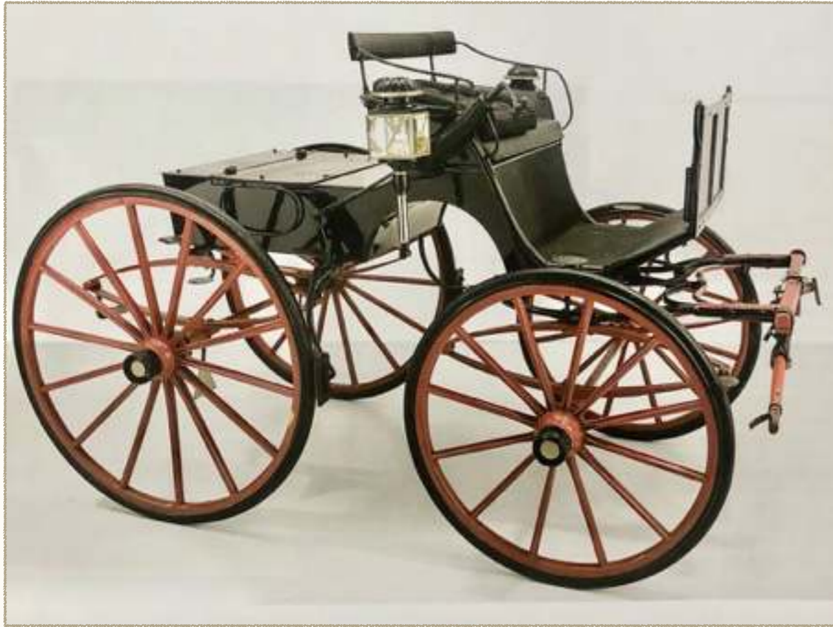
Klapp-Phaëton mit Kapseltyp 3 Nr. 934. (innen auf Kapsel Nr. 58367, wohl von Lemoine). 370kg schwereres Modell. Keil original. Ungewöhnlich primitive, wohl zugefügte Bremse. Siehe auch Buch Rothenburg 2017, 100ff. (Franz Knüsel, Rothenburg ex Fuhrhaltereisler, Zürich)
