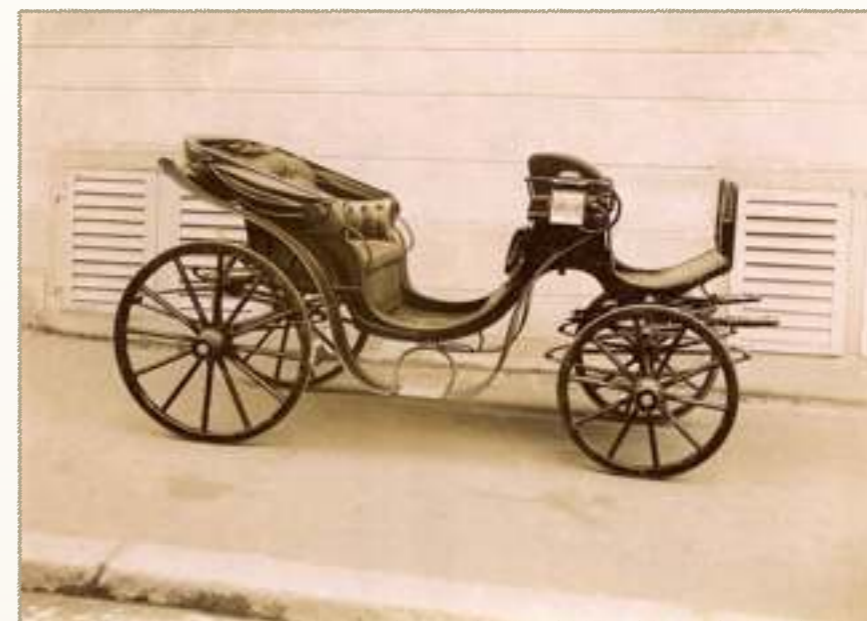
Abb. 45 Diese eindeutig vor der Geissberger-Fabrik aufgenommene Mylord weist Radkapseln mit der Gravur „KAUFFMANN A BALE“ auf, stammt also aus Basel. Es handelt sich offenbar um einen älteren Wagen (Abnützungsspuren an den Rädern und am Bodenteppich), der bei Geissberger an Zahlung genommen und zum Wiederverkauf revidiert wurde (Bremsklötze bereits erneuert).
