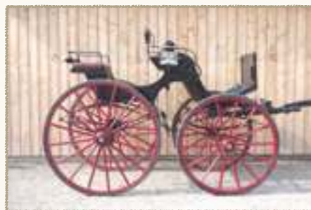
Abb. 13 Geissberger-Phaëton der Zeit um 1885 mit grossen Rädern und Vordergestell ganz aus Eisen. Die Patentnaben bestehen aus Metall.
