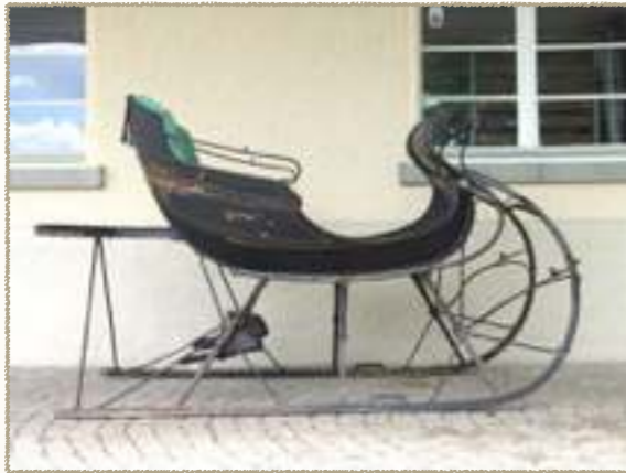
Abb. 76 Importierter Albany Cutter mit von Geissberger erhöhter Rückenpartie und angefügter Sitzpritsche.
