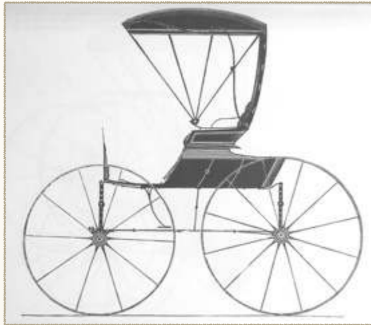
Abb. 72 Amerikanischer Buggy von 1862 mit ähnlichem Kasten und Halbverdeck wie der Geissberger-Spider Nr. 190. (Berkebile 1978, S. 51)
