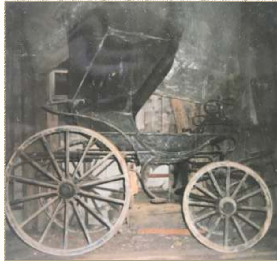
Chaise mit Kapseltyp 2. Hinten mit Steckrahmen für Koffer. (1989 bei A. Laub in Bättwil SO)
