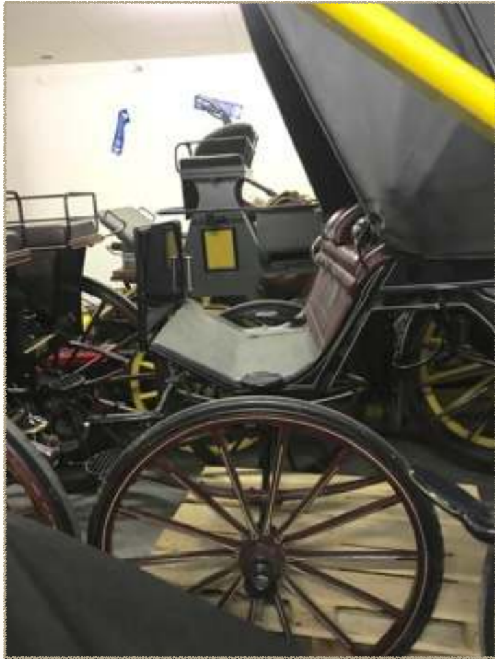
Klapp-Paëton mit Kapseltyp 1. Hinten raffiniert gebauter Klappsitz zum Zusammenstecken bei aufgeschlagenem Deckel. Steckverdeck. (2016 Sammlung Lukas Boesch, Bättwil SO)
