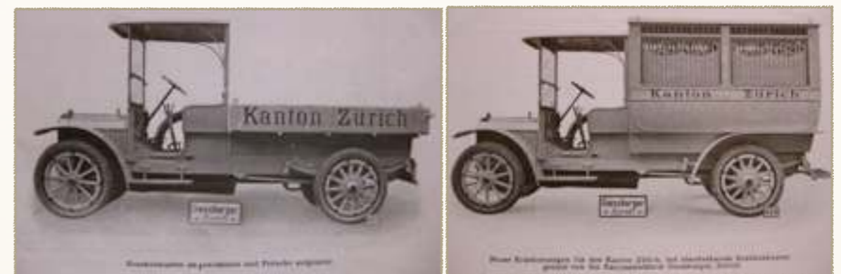
Abb. 54 Dasselbe Fahrzeug in den beiden Versionen als Pritschen- und als Krankenwagen aus der Zeitschrift „Deutsche Fahrzeug-Technik“.
