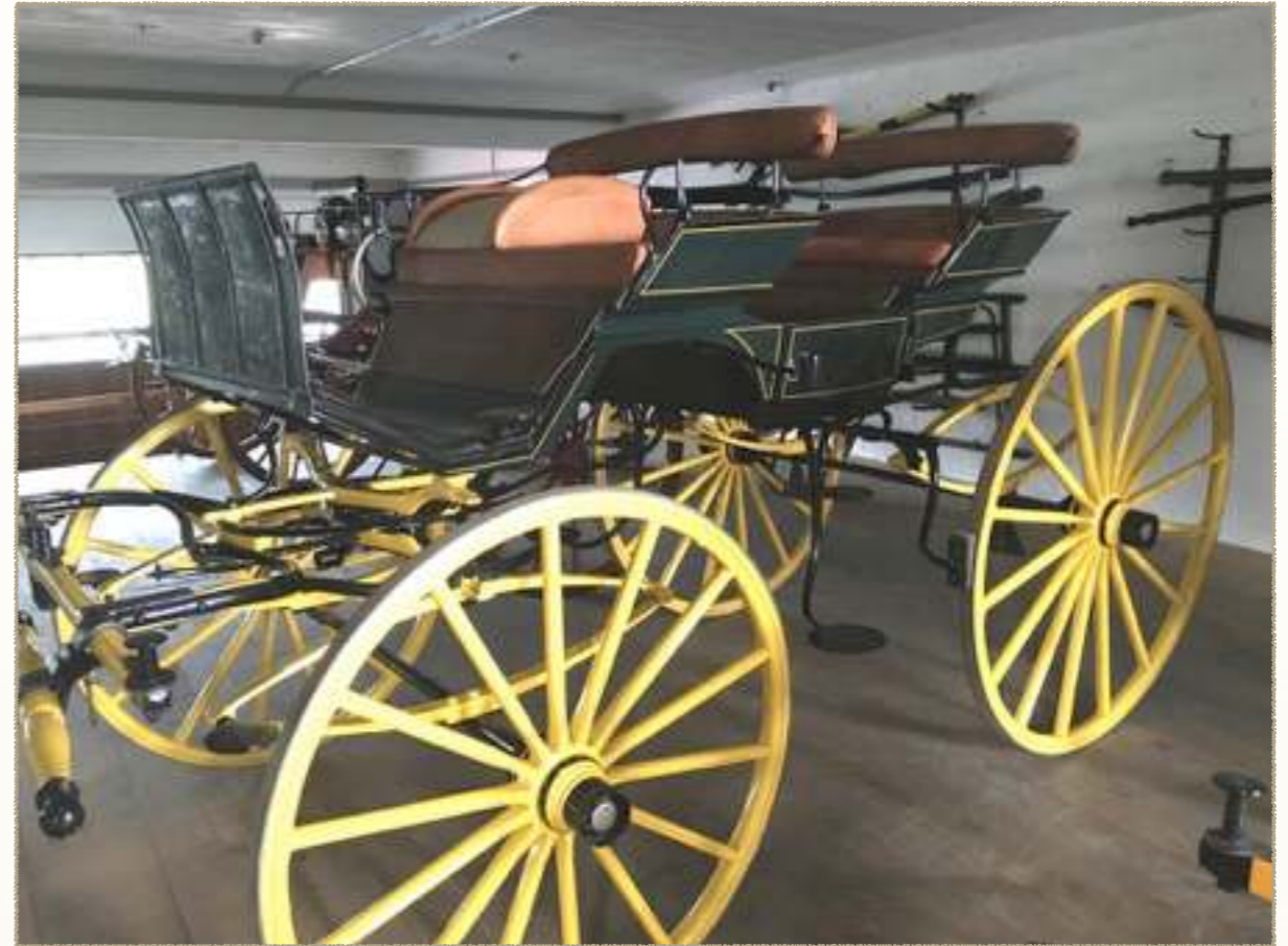
Siamesen-Phaëton Nr. 2352 mit Kapseltyp 4. Der Wagen stammt aus der bekannten Firma Bally in Schönenwerd SO. Schwungradbremse, teilweise originales Schweinsleder. Grosses Modell. Rothenburg 2017, 88ff. 373 kg. (Franz Knüsel, Rothenburg)
