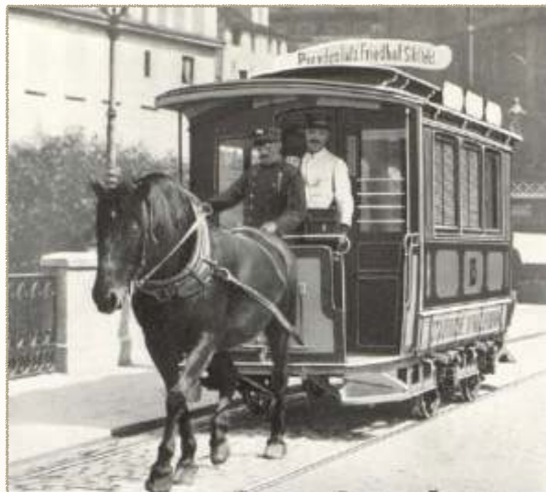
Abb. 20 Von Geissberger nach 1882 gefertigter Pferde-Tramwagen (Aus der Firmengeschichte von 1941)
