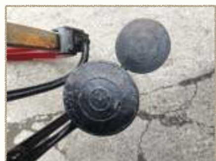
Abb. 82 Spätes Merkmal von Geissbergerwagen: tellerförmige Auftritte.
