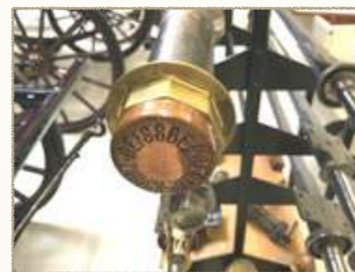
Abb. 83 Bei den Radkapseln wurden oft gravierte Kupferhülsen auf die eigentlichen Kapseln aus Bronze aufgelötet. (Sammlung Toni Meier)
