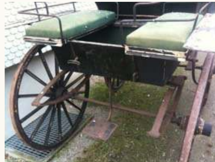
Break-Wagonette Nr. 2581. Modell mit Tafelsitz und ungewöhnlicher Bremse (Gestänge aussen). (2015 im Handel bei Gregor Holenstein, ex Kanton Bern)
