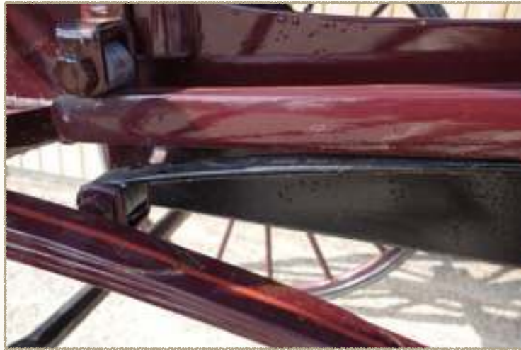
Texas-Cart Nr. 2889 (auf Kapsel) mit Kapseltyp 4. Schwingungsdämpfer an Landen aus Gummi, Fussbremse. (Thomas Würgler ex Ernst Saxer)
