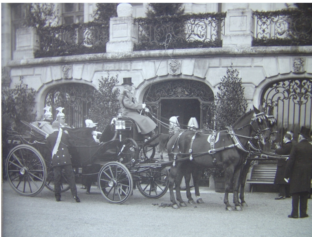
151 Von Wagenbauer Mayer in München für den Fürstenbergischen Hof in Donaueschingen gebaute, achtfach gefederte Kalesche. Foto anlässlich einer Hochzeit im Jahre 1912 mit Kaiser Wilhelm II. im Wagen.
